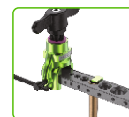
Rura miedziana wchodzi do otworu, a płytka ograniczająca znajduje się na rurze miedzianej
