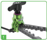
1 Listwa rozszerzająca jest włożona do korpusu
