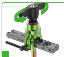
Przesuń korpus do odpowiedniego otworu
