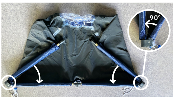
Krok 2 - Złóż 4 krawędzie pod kątem 90 stopni.
